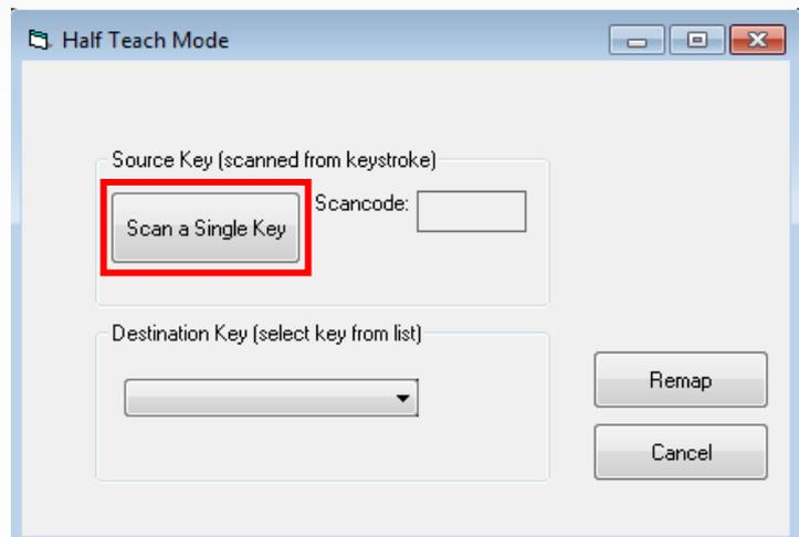
**4.** Im Feld „**Scancode**“ wird der Code, welcher von der betätigten Taste ausgegeben wird, angezeigt.
